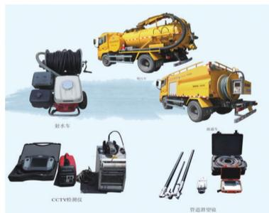
专业运维设备，包括吸污车、疏通车、巡检车、CCTV检测仪、管道潜望镜等。
